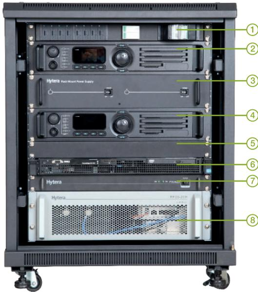
BS de duas repetidoras de 400-470 MHz 600\*600\*675 mm
