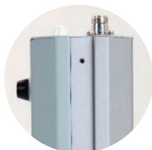
O RD626 é um repetidor de 25W compacto com mini duplexador embutido e fonte de energia. Seu design inovador permite suportar facilmente a instalação em parede. Suas funções DMR e analógica satisfazem requisitos de dados e voz e ajudam a tornar a migração digital mais fácil e barata. Múltiplos locais podem ser conectados via IP para suportar uma área ampla e flexível e grande cobertura em edifícios, nas áreas internas e externas.
